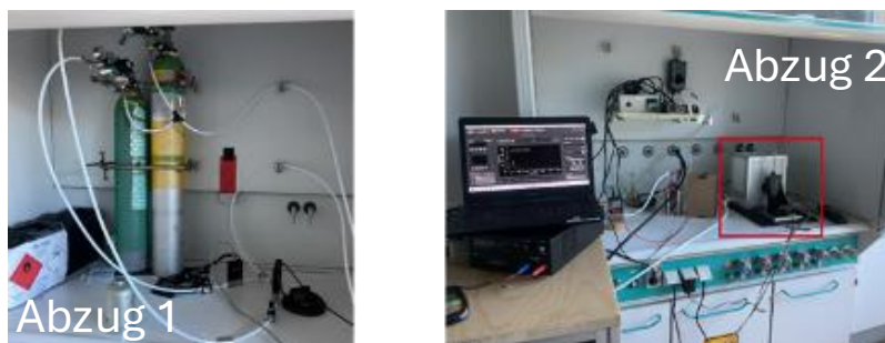
Abbildung 16: Finaler Versuchsaufbau Durchflussszelle. Links abgetrennte Gasversorgung in Abzug 1. Rechts Abzug 2 mit optisch abgeschirmter und temperierter Durchflussszelle, rot umrandet, und Peripherie zur Gasversorgung.
