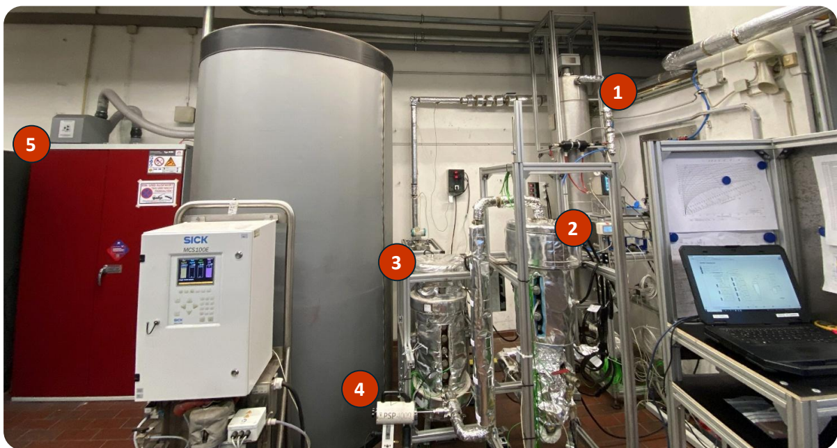
Abbildung 18: Versuchsaufbau zur Durchführung der Batchversuche im Technikum der FE 2 – Konditionierung (1), Wirbelschichtreaktor (2), Gewebefilter (3), Messstelle (4) und aktiv entlüfteter Gasschrank (5)
