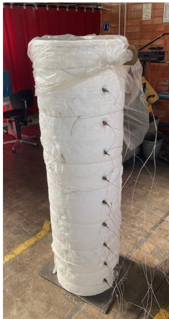
Abbildung 5.1: Foto des isolierten Reaktionsrohres vor Einsetzen in den Ofen.
