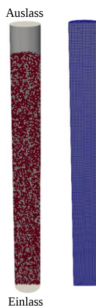
Abbildung 14: DEM-CFD Kopplung des Schachtreaktors: DEM-seitige Partikelverteilung (links), Poröses Medium zur Lösung der CFD (rechts)
